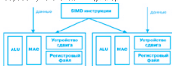
Рис. 5. Структурная схема параллельной обработки типа SIMD
